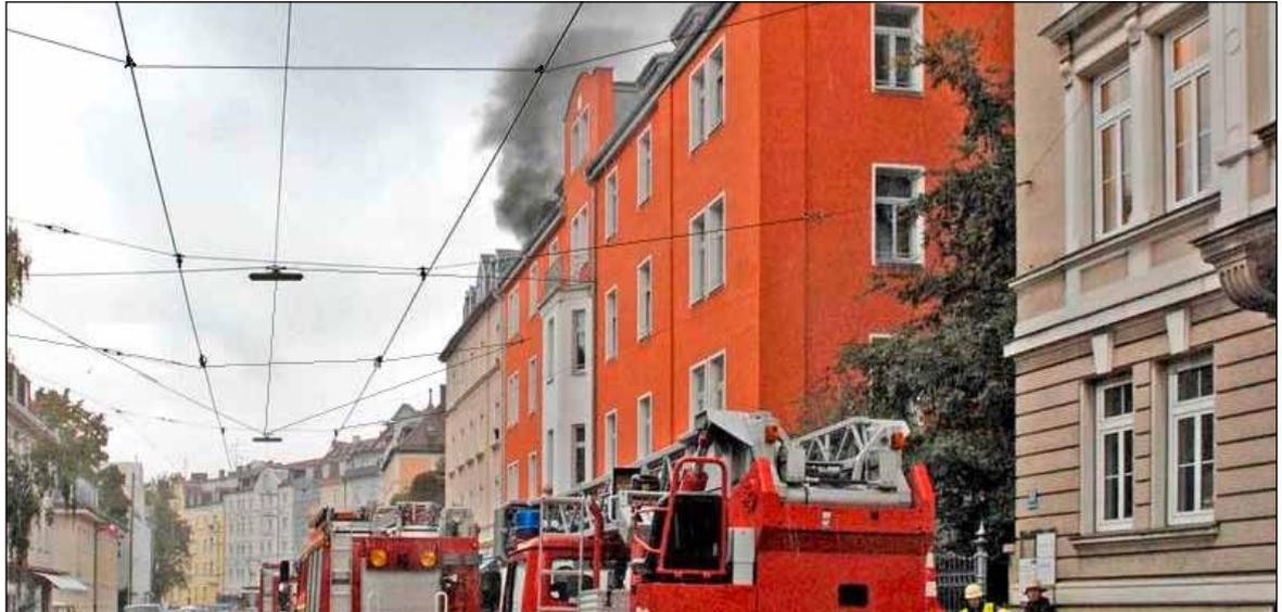
Um den Einsatz einer Drehleiter zu ermöglichen, muss gewährleistet sein, dass sich keine Oberleitungen von Straßenbahnen, Straßenbeleuchtungen oberhalb der Aufstellfläche und im Schwenkbereich befinden. In diesem Fall muss die Sicherstellung des 2. Rettungswegs auf andere Weise sichergestellt werden, zum Beispiel durch einen weiteren Treppenraum.
