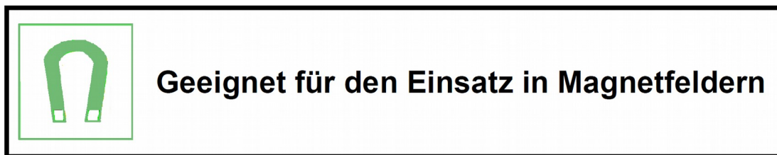
Bild 2: Kennzeichnung eines tragbaren Feuerlöschers, der für den Einsatz in Bereichen mit hohen statischen Magnetfeldern geeignet ist
