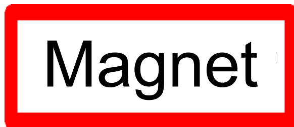
Bild 1: Beispiel für ein Hinweisschild „Magnet“ für die Feuerwehr gemäß DIN 4066
