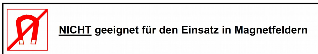
Bild 3: Kennzeichnung eines tragbaren Feuerlöschers, der für den Einsatz in Bereichen mit hohen statischen Magnetfeldern NICHT geeignet ist
