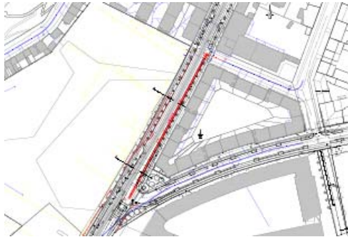
Abschnitt 1: Weilerstraße/Regerstraße Microtunneling DN 1200 + offene Bauweise
